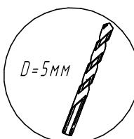
Для крепления надстройки к крышке стола (или комода) необходимо с не лицевой стороны крышки - досверлить 6 отверстий сверлом диаметром 5мм.
