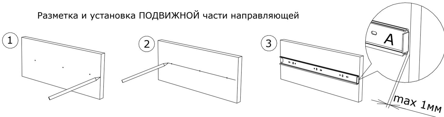
Используя любой разметочный инструмент (карандаш, маркер и пр.) необходимо провести линию через базовую разметку на деталях мебели
