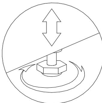
Для компенсации неровностей пола, произвести регулировку опор
