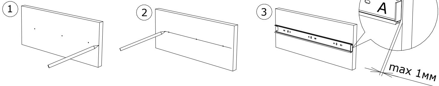
Используя любой разметочный инструмент (карандаш, маркер и пр.) необходимо провести линию через базовую разметку на деталях мебели
