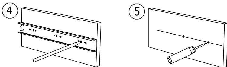
Соблюдая технологические отступы от переднего края деталей необходимо приложить элементы направляющих на линии разметки и отметить, через предусмотренные отверстия в направляющих, места их будущего крепления (достаточно 3-х точек крепления для каждого элемента выдвижной направляющей).
