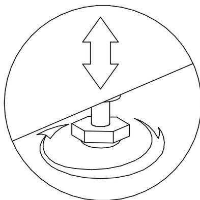
Для компенсации неровностей пола, произвести регулировку опор
