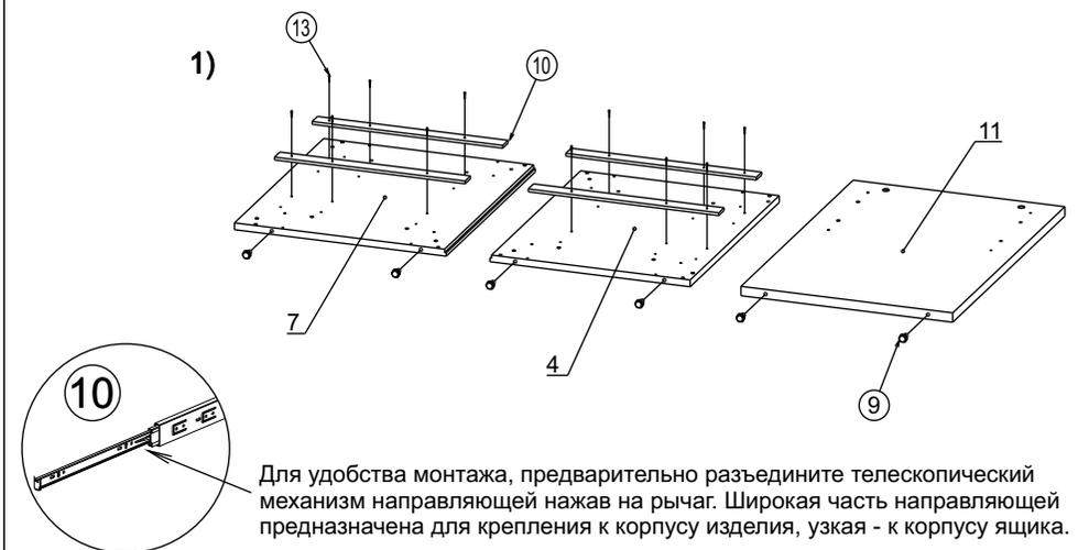
\*\* В случае несовпадения присадки под направляющие (позиция №10) на деталях 3, 4, и 7, необходимо использовать существующую присадку для определения линий расположения разметки и переноса на нее отверстий (наколок), соответствующих типу направляющих, входящих в комплект поставки. Достаточно 3-х точек крепления для каждого элемента направляющей.
